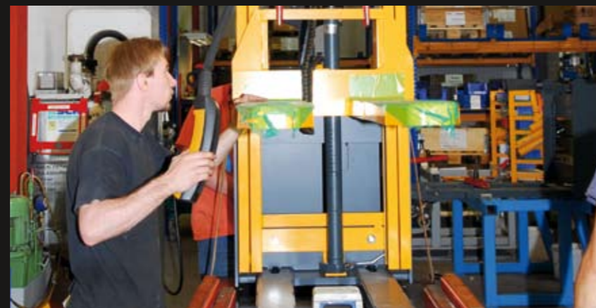
4 Montage der elektrischen und hydraulischen Anschlüsse
